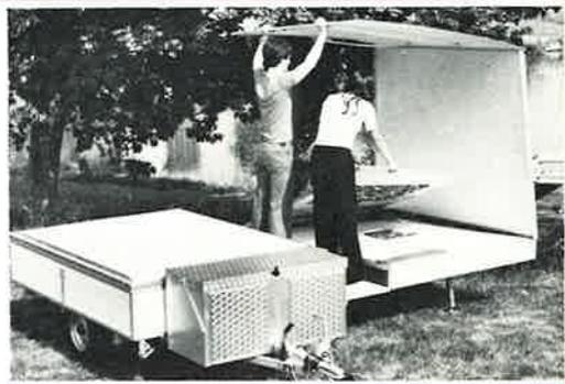
10 Heben Sie zusammen das Dach hoch, dann mit der freien Hand die Rückwand.
