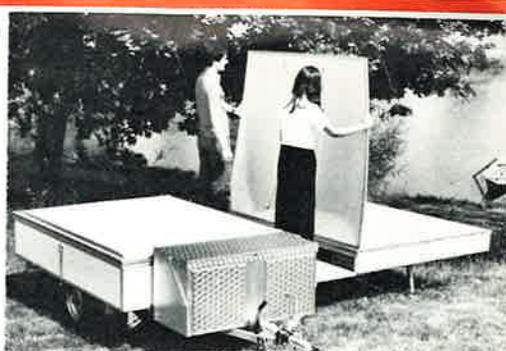
9 Nehmen Sie das Dach mit einer Hand, mit der anderen Hand halten Sie das äussere Profil. Die Montage kann beliebig bei der Tisch- oder Sitzbankseite begonnen werden. Bei starkem Wind jedoch muss gegen den Wind geöffnet werden.
