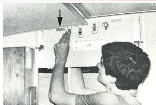
19 Speizen Sie die Seitenwände auseinander, indem Sie den Rücken gegen die Wand der Tischseite drücken. So lässt sich der Verbindungsladen leicht einführen und verriegeln. Wenn nötig, hintere Stütze höher drehen
