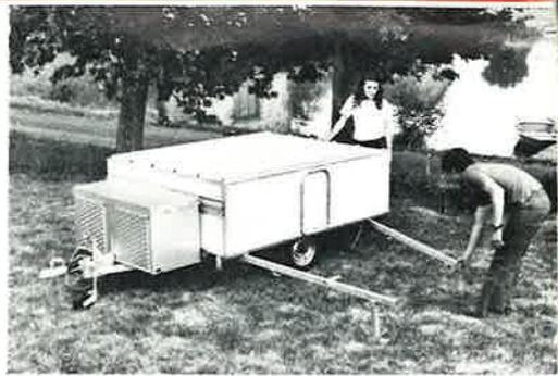
1 Vor dem Abhängen des Rapido lassen Sie die Teleskop-Deichselstütze herunter. Auf der gewünschten Höhe fixieren. Anhänger an die gewünschte Stelle rollen. Auf abfallendem Gelände soll die Deichsel in Richtung des Hangs gehen. Handbremse anziehen und blockieren. Anhänger mittels der Deichselstützen-Kurbel in eine möglichst ebene Fläche ausrichten, evtl. mit Hilfe einer Wasserwaage.
