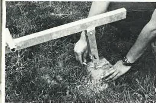
4 Die Schraubenfüsse auf Holzbretchen abstützen. Nach Kontakt mit den Brettschen noch zwei Umdrehungen machen. Es ist wichtig, dass diese Operation von der gleichen Person bei beiden Füßen ausgeführt wird.
