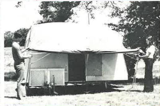
**34** Beim Schliessen des Wohnwagens, vor dem Zuklappen des Deckels (wenn der Wagen offen liegt wie ein Buch), müssen Dach und Seitenwände festgemacht werden. Beide ausziehbaren Haken ins Scharnier klemmen (Foto A) und beide gegenüberliegenden Innoxhaken auf das Dachprofil niederdrücken (Foto B).
