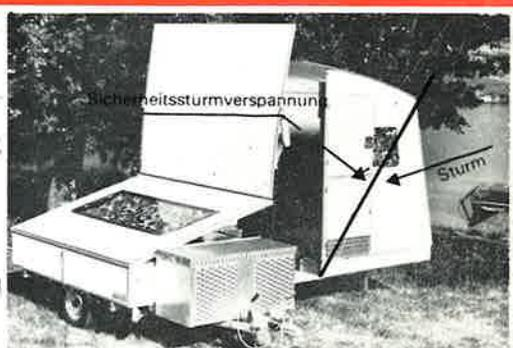
15 Indem der halbe Wohnwagen gegen die Windseite aufgestellt ist, ist die andere Hälfte geschützt. Zweite Caravan-Hälfte auf gleiche Art aufstellen. Bei sehr starkem Wind Sturmverspannung anbringen.
