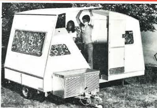
17 Bei der Demontage umgekehrtes Vorgehen, indem Sie sich vergewissern, dass das öffnende Fenster gut geschlossen und die Vorhänge gezogen sind. Es ist wichtig, die Rückwand in vertikaler Haltung zu haben, damit die Seitenwände, besonders die unteren Ecken, genügend Platz zum Hereinklappen haben. Immer die rechte Seitenwand zuerst herunterklappen.
