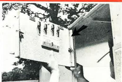
18 Wenn nötig, beide Dachhälften mit Hilfe der Kurbel an der Teleskop-Deichselstütze perfekt ausrichten (wie beschrieben in photo 20). - Verbindungsflächen von aussen her, zuerst hohe Seite, einführen und verriegeln.
