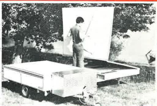
24 Die Montage kann auch von einer einzigen Person durchgeführt werden ; Dazu benützt man die auf der Dachinnenseite angebrachten Riemen.
